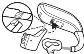
2. Mueva el adaptador hacia la parte inferior del audífono.
