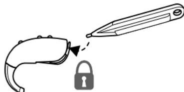
Pour déverrouiller le porte-pile, il vous suffit de répéter la même procédure mais en poussant le verrou de l'autre côté. Vous pouvez maintenant changer la pile en suivant les indications du chapitre Remplacement de la pile.
