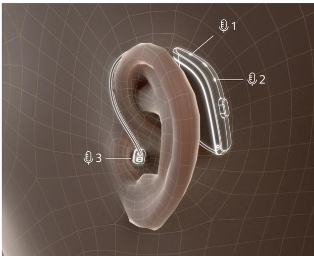
Figure 1. Le module écouteur M&RIE comporte un microphone dans le conduit auditif. Cela lui permet de collecter un son qui préserve les signaux acoustiques individuels du pavillon, de la tête et du torse qui aident à la localisation spatiale.<sup>6</sup> Les microphones de l'appareil peuvent fournir un SNR supplémentaire dans des conditions d'écoute difficiles.
