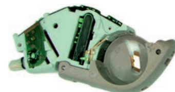
Hörsystem MIT iSolate nanotech nach mehreren Wochen in einer Feucht- und Wärmekammer
