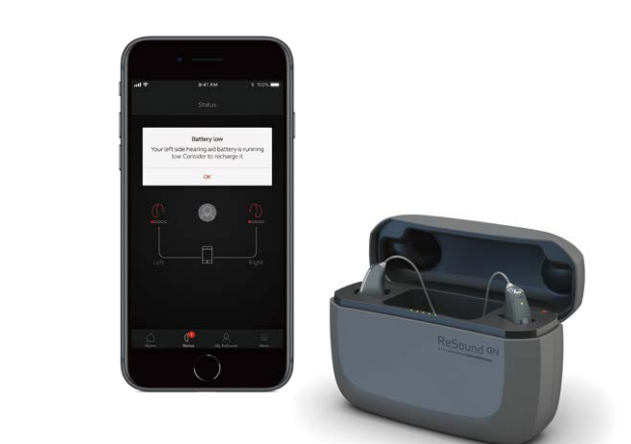
図1. リサウンド・リンクス クアトロの充電式システムの全容。家庭内での設置用として、または携帯モバイル用として使用できる小型充電器。ワイヤレス充電方式を採用し、補聴器の電池残量はリサウンド・スマート3Dアプリ™でいつでも確認できる。
