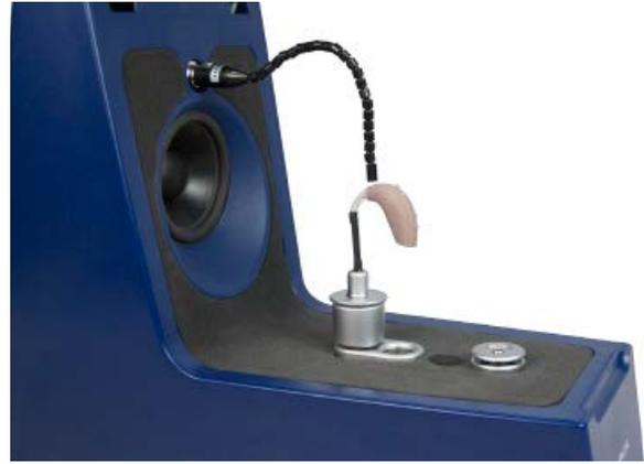
Figura 2: Colocación del audífono y del micrófono de referencia en AURICAL HIT.
