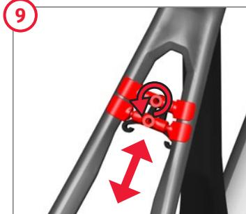
Der Abstand des Schutzblechs lässt sich über die Position der Brücke und des Kunststoffhakens regulieren. Durch Drehen des Mittelteils werden die Enden durch das Gewinde verschoben und können so an unterschiedliche Rahmengrößen angepasst werden.
