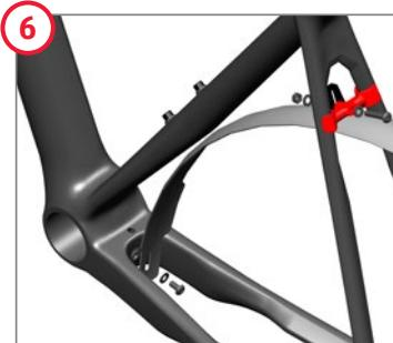
Das Schutzblech an Tretlageraufnahme (Schraube M5 \* 10 mm, Unterlegscheibe M5) und an Aufnahme an der Sitzstrebengelenk (Schraube M5 \* 30 mm, 2x Unterlegscheibe M5, Mutter M5) schrauben.
