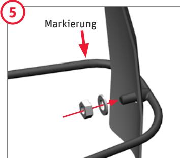
Die hintere, längere Strebe ist an der Seite mit einer kleinen „Delle“ markiert. Die Strebe mit Mutter M5 und Unterlegscheibe M5 an das Schutzblech schrauben.
