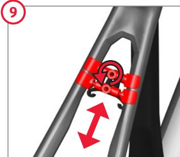
La distance du pare-boue peut être réglée à l'aide de la position du pont et du crochet en plastique. En tournant l'élément central, les extrémités sont déplacées sur le filet et peuvent ainsi s'adapter aux différentes tailles de cadres.
