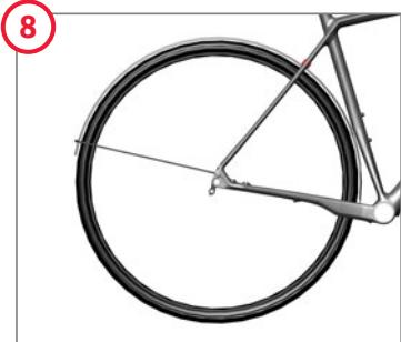
Le pare-boue doit présenter sur toute sa longueur la même distance par rapport au pneu. Une distance insuffisante peut au pire endommager le pneu par friction.
